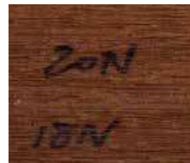
Presión 20N. No hay marca evidente
